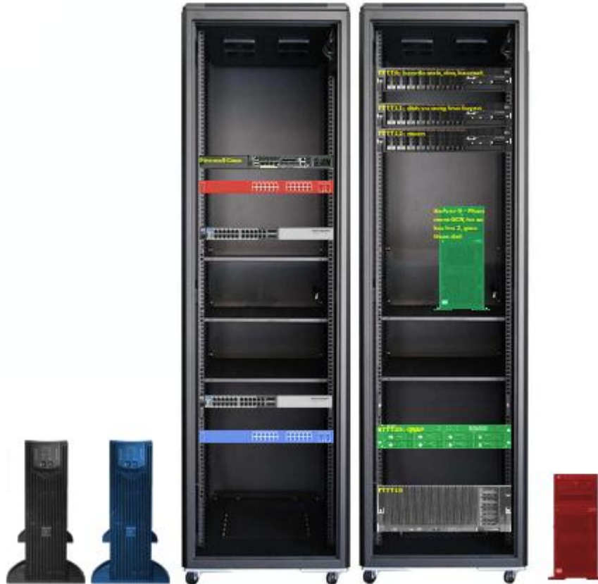
Giao diện bản đồ tủ rack, thiết bị, và trạng thái thiết bị dựa trên màu sắc
